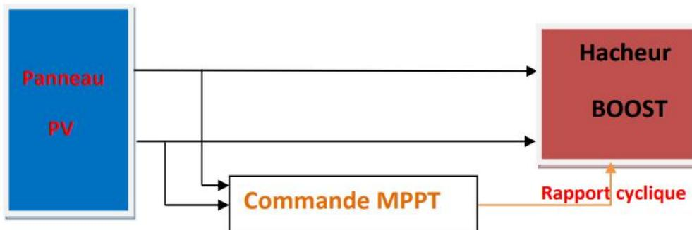
Figure 1.27. principe générale d'une commande MPPT.
