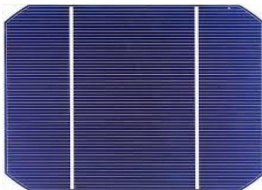
Figure 1.3. cellule en silicium monocristallin
