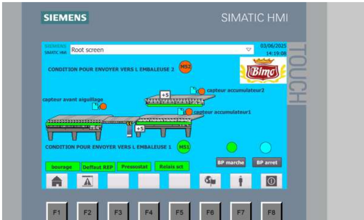
Figure 3. 11: CONDITION POUR ENVOYER VERS L EMBALEUSE 1
