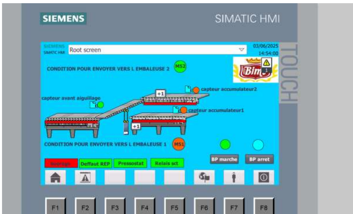
Figure 3. 13: SUPERVISER LA LARME DE BOURRAGE
