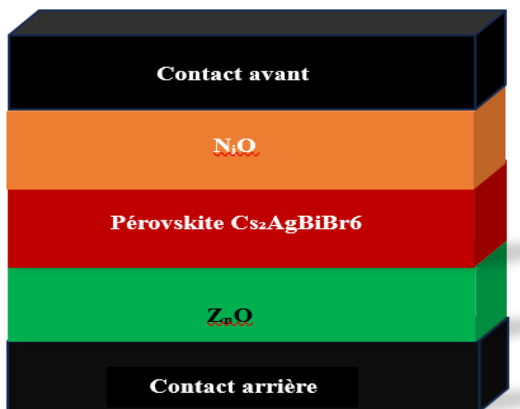
Figure 2.6: Schéma d'une cellule solaire à base de pérovskite \text{Cs}_2\text{AgBiBr}_6
