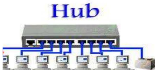
Figure II-4: Equipement physique Hub [7]
