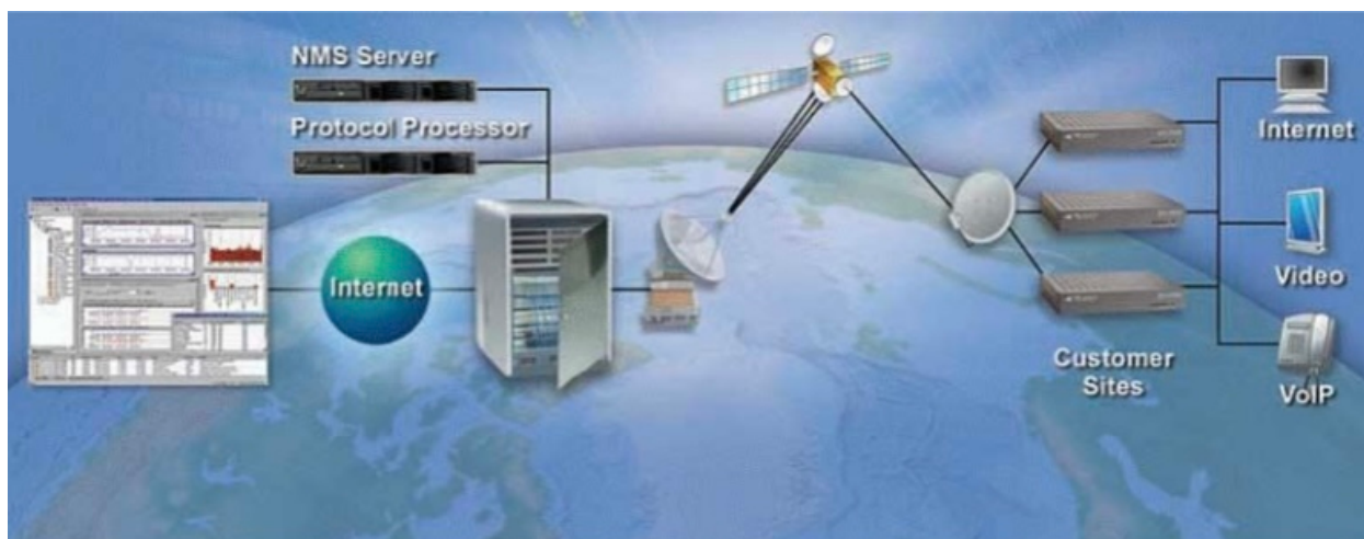
FIG. 2.1: Architecture d'un réseaux VSAT indirect – Source : [29]
