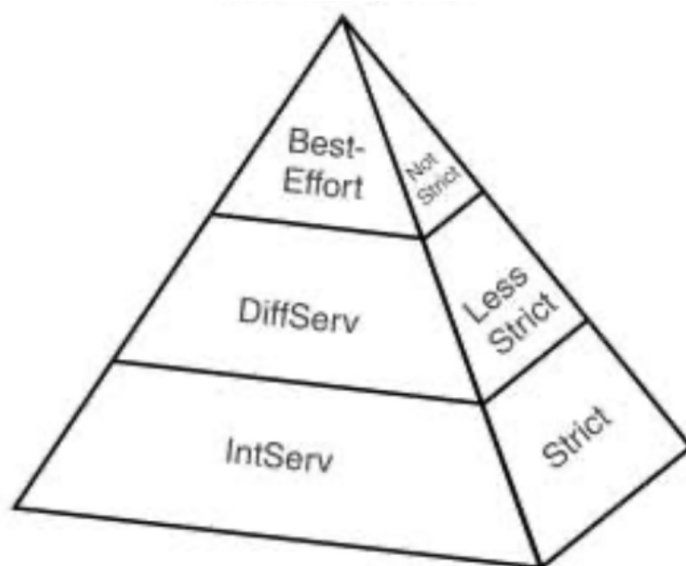
FIG. 3.2: Modèles de Qos – Source : [35]
