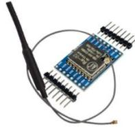
**Figure 0.4** : Module LoRa.
