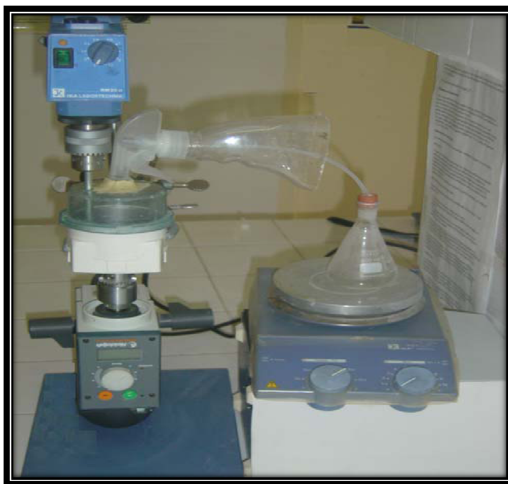
Figure2.3 : Schéma du mélangeur-granulateur conçu [4].
