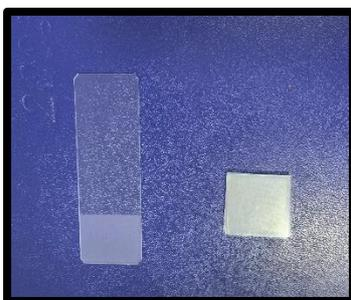
Figure 43 : Lame et lamelle.
