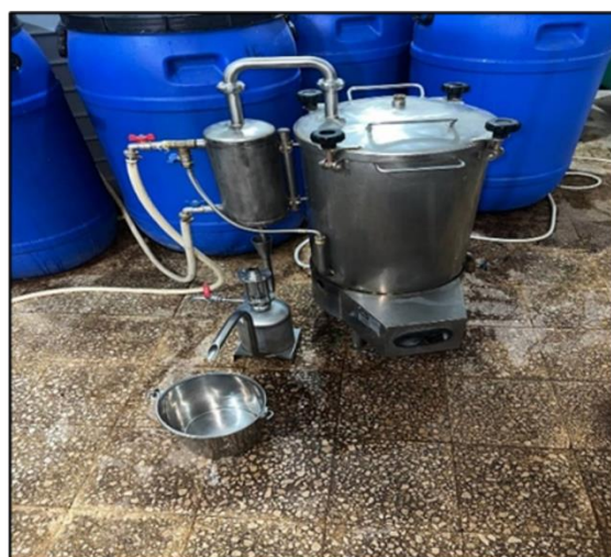
Figure II. 2 : l'extraction de l'huile essentielle de Cedrus atlantica dans un Alambic de 200L
