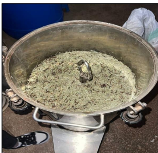
Figure II. 2 : l'extraction de l'huile essentielle de Cedrus atlantica dans un Alambic de 200L
