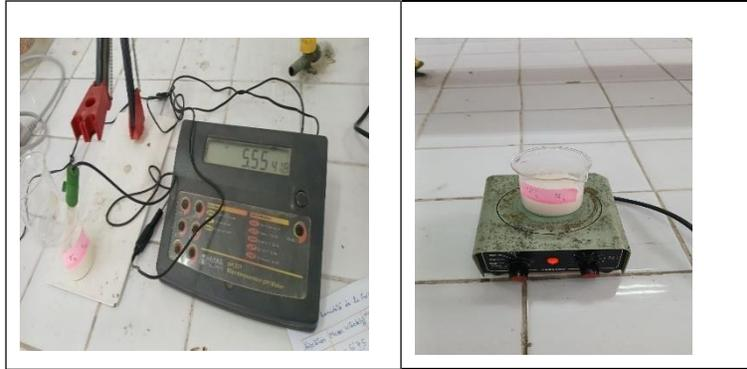
**Figure 16** : Matériels utilisés pour l'évaluation de Potentiel hydrogène (Original, 2025)
