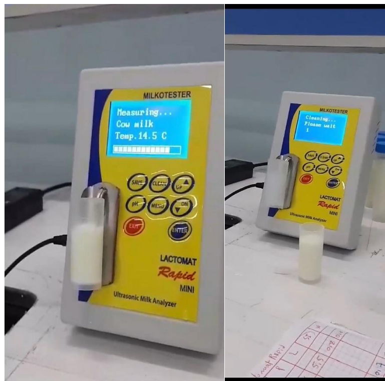
Figure 4 : Milkotester utilisé pour l'analyse physico-chimique du lait (Photo personnelle).
