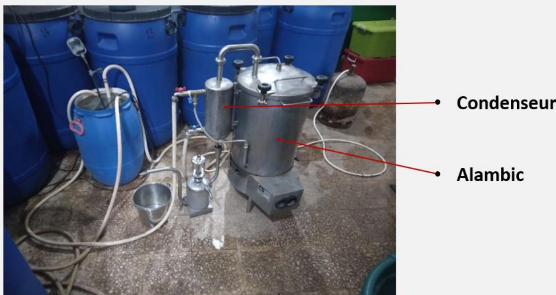
Figure 7 : l'appareil illustre le système de distillation à la vapeur utilisé pour l'extraction de l'huile essentielle de Cupressus arizonica . (Original ,2025).
