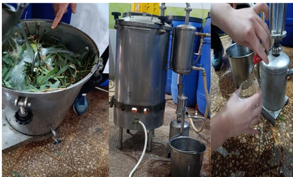
Figure 15: Extraction des huiles essentielles par hydrodistillation de type alambic (originale, 2025).
