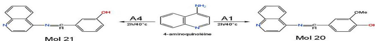
Schéma 2.6 : Synthèses des ligands azotés dérivées de 4-aminoquinoléine avec deux aldéhydes différents.
