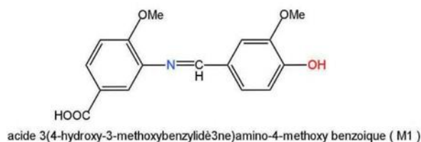
Figure 3.4 : Structure du acide 3(4-hydroxybenzylidène) amino-4-methoxybenzoïque (M1)
