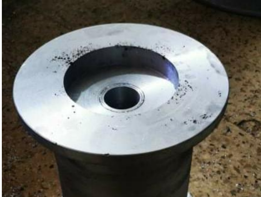
Figure 1.23 : Photo prise après usinage du tambour montrant les défauts de moulage.
