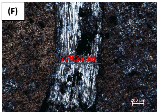
Fifure IV.7 : micro graphies de microscope optique des traces d'usure Hill des échantillons (1,2,3,4,5,6) respectivement (A,B,C,D,E,F).
