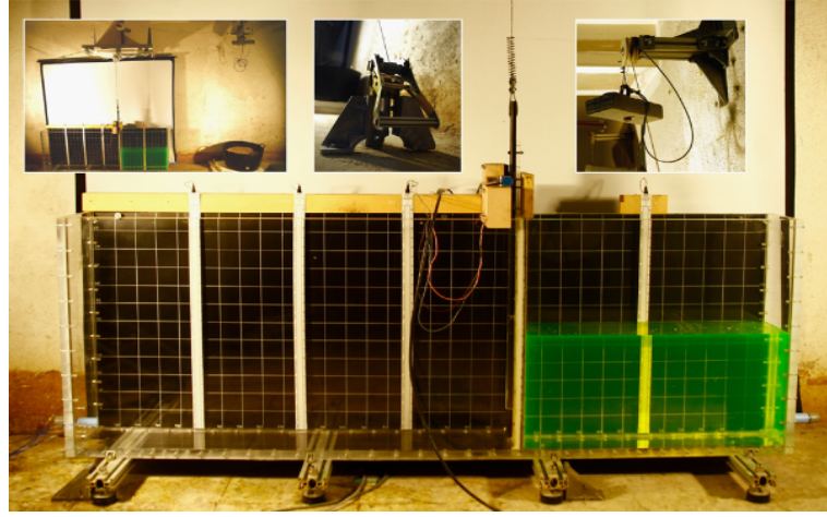
Fig. 3.1 Détails géométriques et description de la configuration expérimentale de la rupture de barrage [64].
