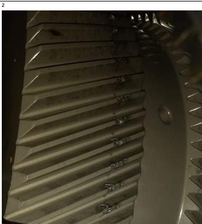
Figure 2. 15 Endommagement des dents des Pignons planétaire1
