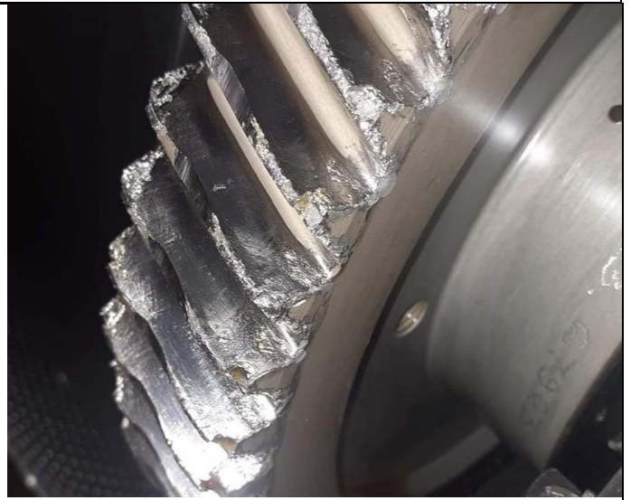
Figure 2. 12 Endommagement de la denture des engrenages2
