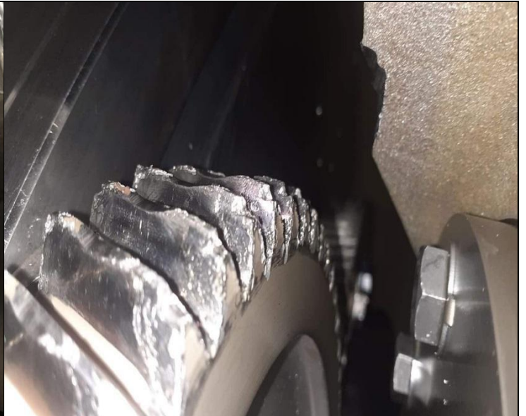
Figure 2. 10 Endommagement de l'arbre Endommagement de l'arbre 2
