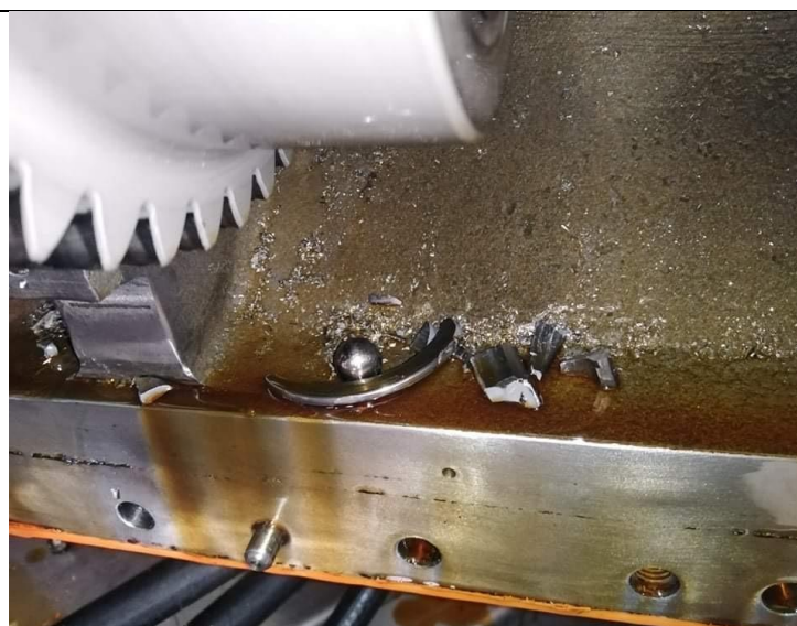
Figure 2. 7 Dépôt de débris métallique1
