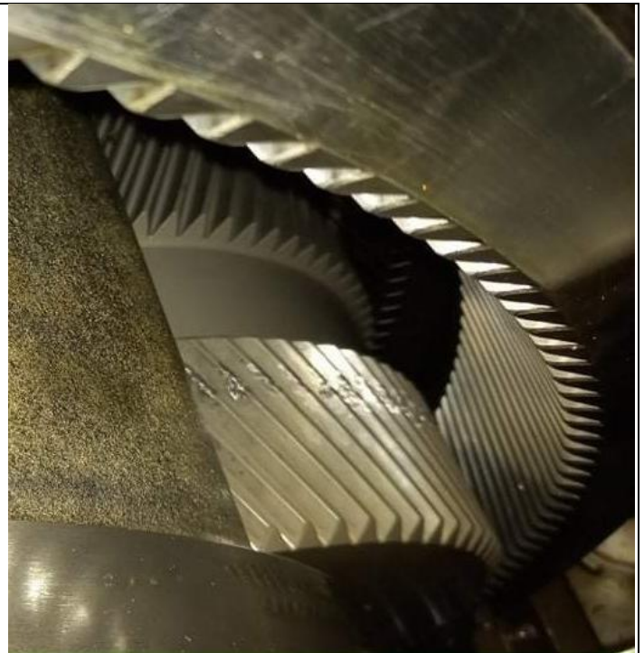
Figure 2. 16 Endommagement des dents des Pignons planétaire2
