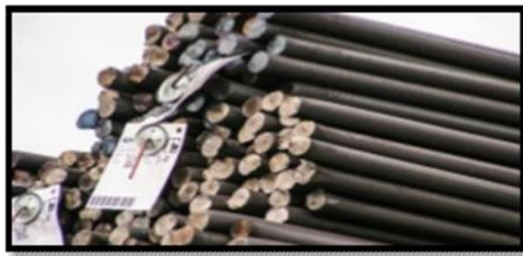
Figure I.10 : les aciers ronds lisses.
