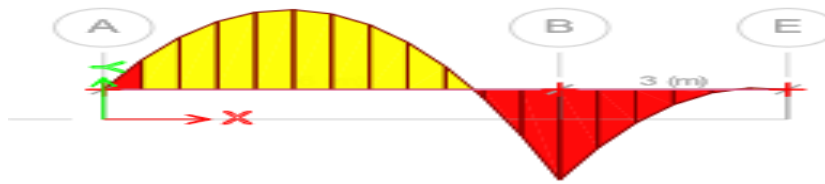
Figure III.22 : diagramme de moment fléchissant à ELS
