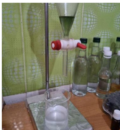
Figure 9 : séparation des huiles esentieeles de l' hydrolat
