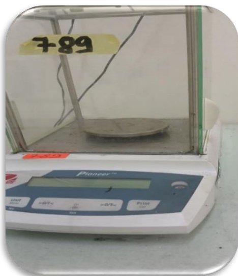
Photo 02 : Balance mono plateau \pm 0.1g
