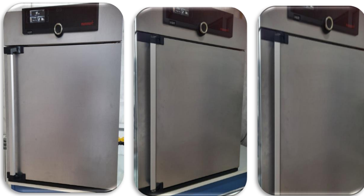
Photo 01 : Incubateur réglable à 37° et 50° et à 40°
