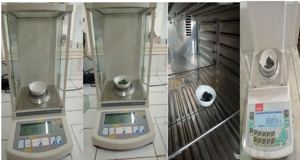
Figure 14 : Détermination de l'humidité (original,2025).
