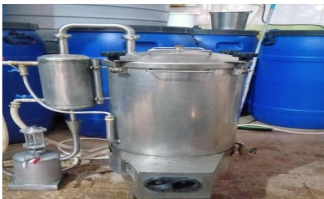
**Figure 16** :dispositif d'extraction un alambic
