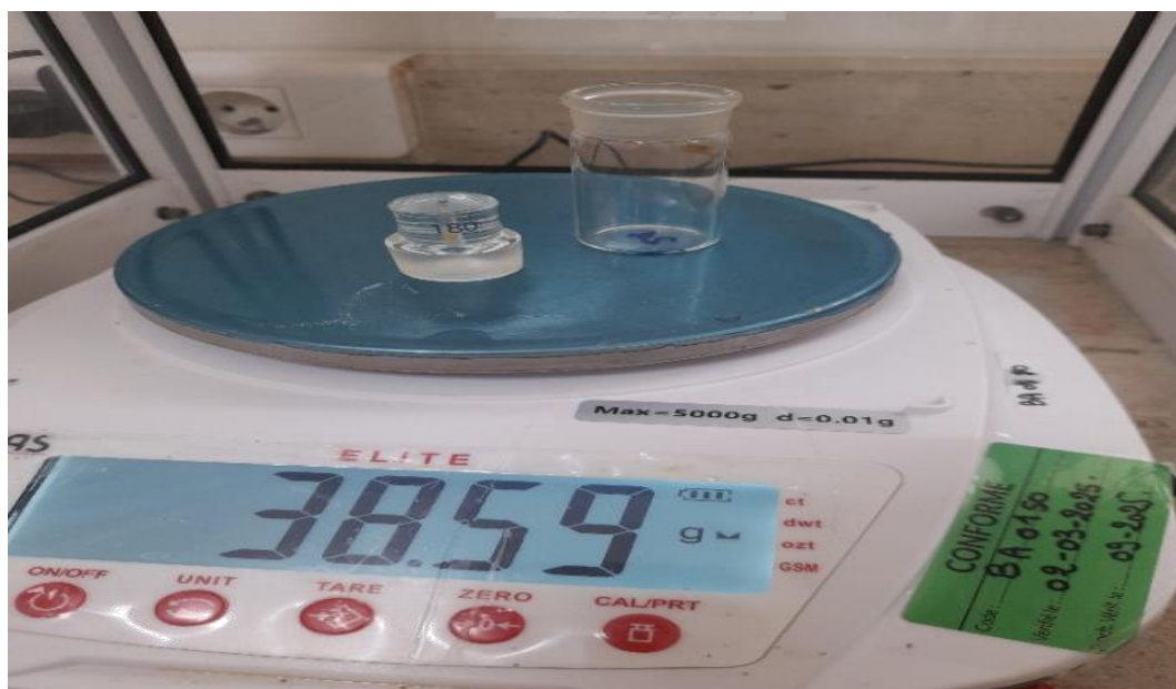
Figure N° 23 : Mesure de la densité (Photo personnelle, 2025)
