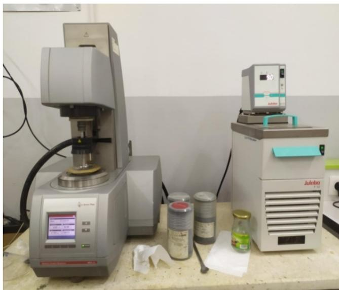
Figure 2-12 : Rhéomètre rationnel Anton Paar MCR 302 et son bain thermostat Julabo F25
