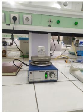
Figure 0-2 : Agitation et chauffage du mélange PMMA/PSU.
