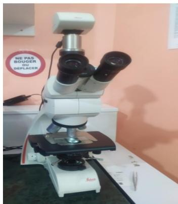
Figure 2-8 : Microscope métallographique type : trinoculaire a quatre objectifs DM750M de LEICA.
