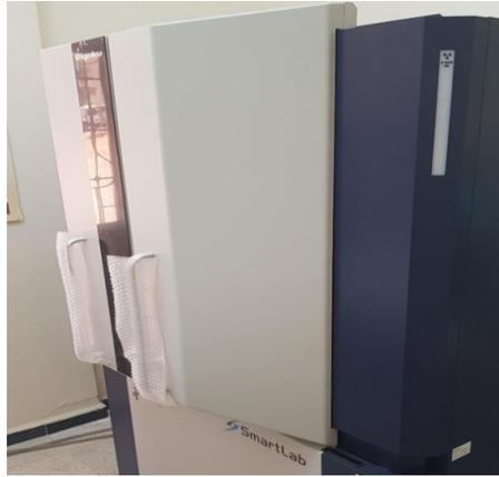
**Figure 2-10 : Diffractomètre de rayon X RigakuSmart ab**
