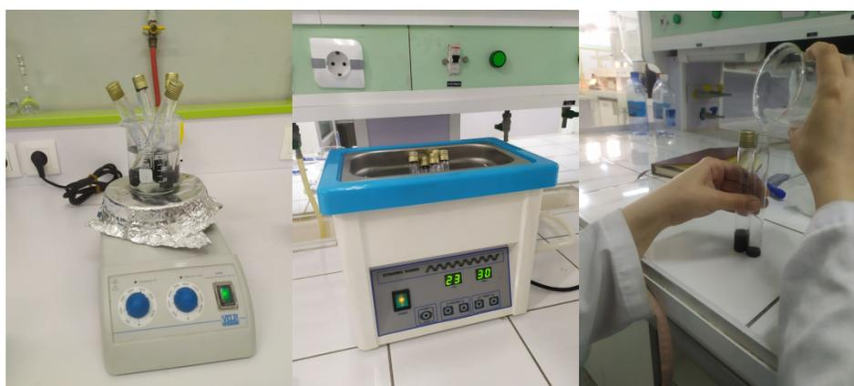
Figure 2-6 : Etapes de préparation des échantillons PMMA/PSU/Graphite pour l'analyse Rhéologique.
