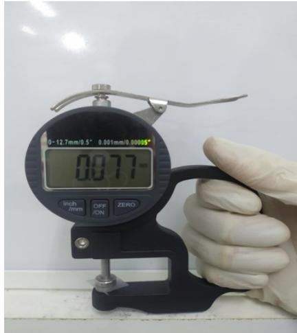
Figure 2-9 : Micromètre numérique.
