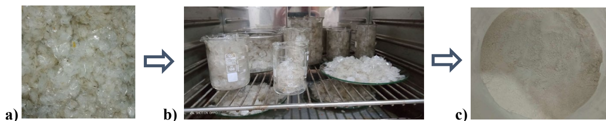
Figure II. 1. Processus de préparation de l'adsorbant : a) Lavage, b) Séchage et c) Broyage.
