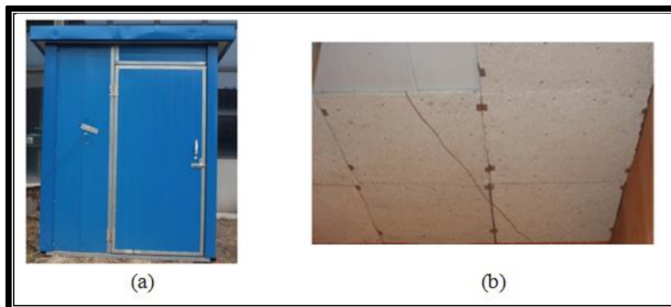
Figure 2. 11. (a): Apparence de la cellule, (b) : MCP à forme stabilisée dans le planché [213]
