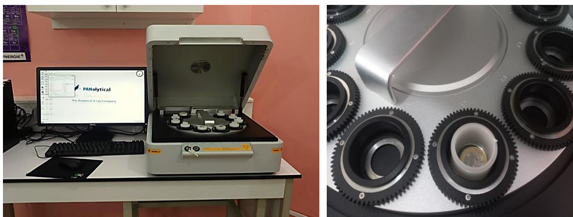
Fig. II.03. Dispositif expérimental d'ED-XRF type Epsilon 3XL, PANalytical (Disponible au niveau du laboratoire FUNDAPL de l'université de Blida 1)
