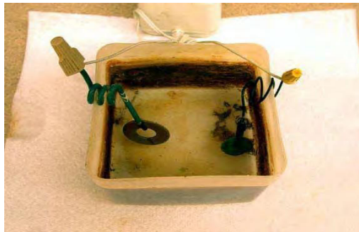
Fig.I.06. Nettoyage des pièces par électrolyse [46].
