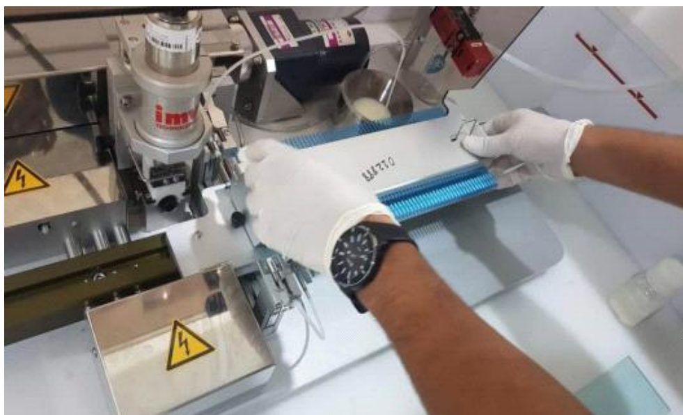
Figure 17 : Machine de remplissage et de sertissage de semence( hadjalla ikram , oukham yasmine ,2020)
