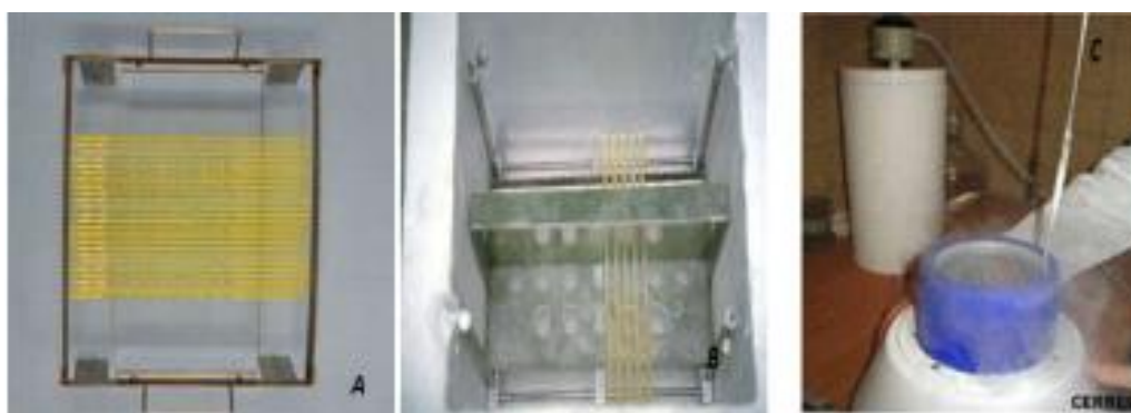
Figure 18 :(A) paillettes déposées sur une grille puis, (B) placées dans une boîte de congélation en polystyrène au-dessus de l'azote liquide, puis stockées dans une cuve d'azote liquide (C) ( hadjalla ikram , oukham yasmine 2020)
