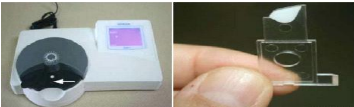
Figure 13 : photomètre Minitube avec cuvette remplie en sperme (John Dascanio. 2014)
