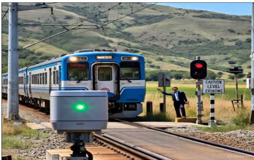
Figure 2-11 : Passage à niveau équipé d'un LiDAR.
