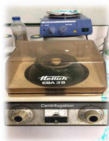
D Filtrat est ensuite mis en centrifugation à 1000 tours/min pendant 10 min
