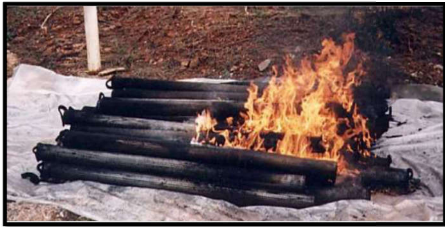
Figure 2.2: La poudre noire (caractère pyrophorique) après avoir été retirée d'un séparateur de filtre [74].
