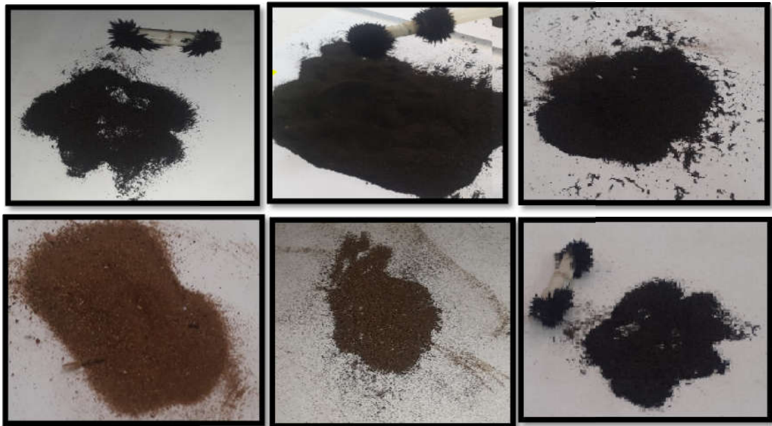
Figure 3.6 : Séparation sélective des compositions de poudre noire constituée de partie magnétique et autres minéraux (échantillons transportés).
