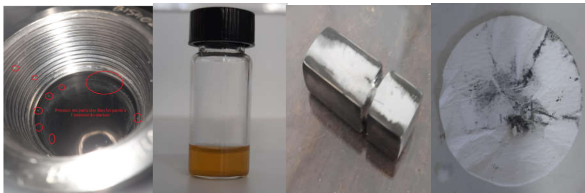
Figure 3.4 : Particules déposées et particules en suspension générées durant l'expérience en présence du gaz brut.
