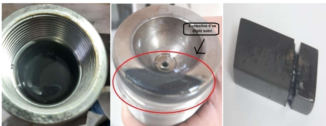
Figure 3.3: Réacteur et le coupon en fin de réaction.
