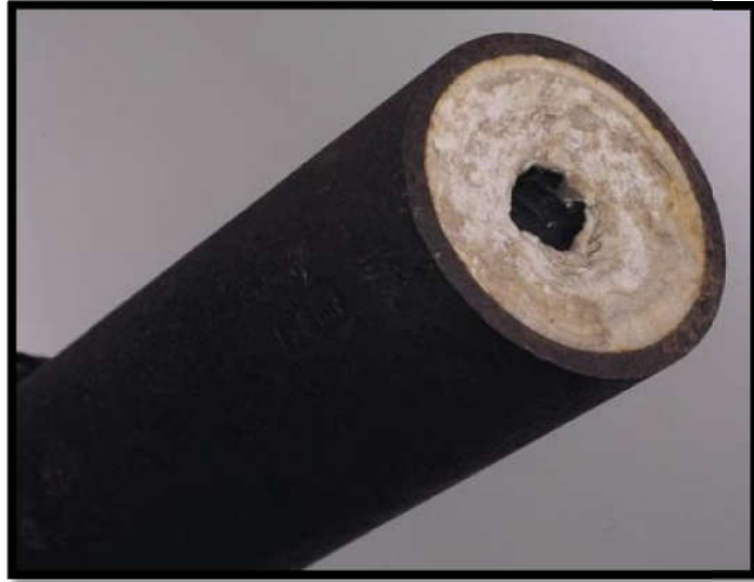
Figure 1.4 : Dépôt du sulfate de baryum ( \text{BaSO}_4 ) [49].
