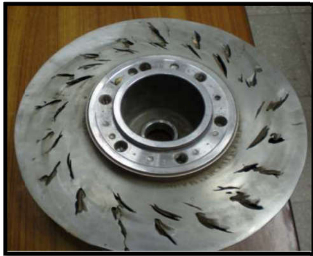
Figure 2.3 : Roue d'un compresseur centrifuge érodée par de la poudre noire [83].
