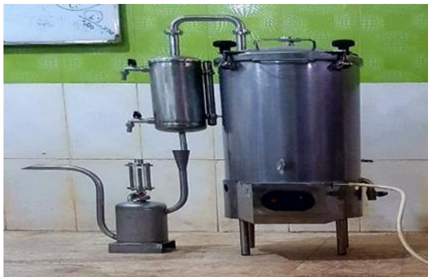
Figure 3: dispositif d'extraction des He par hydro distillation.
