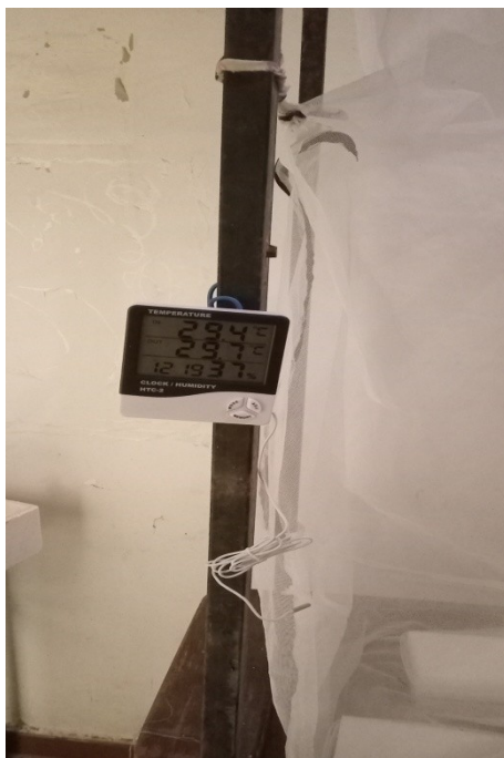
Suivi de la température et de l'humidité par un thermo-hygromètre
