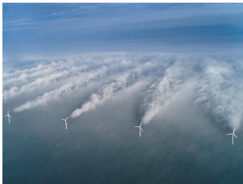
Figure 3 l'effet de sillage dans une ferme éolienne [15]
