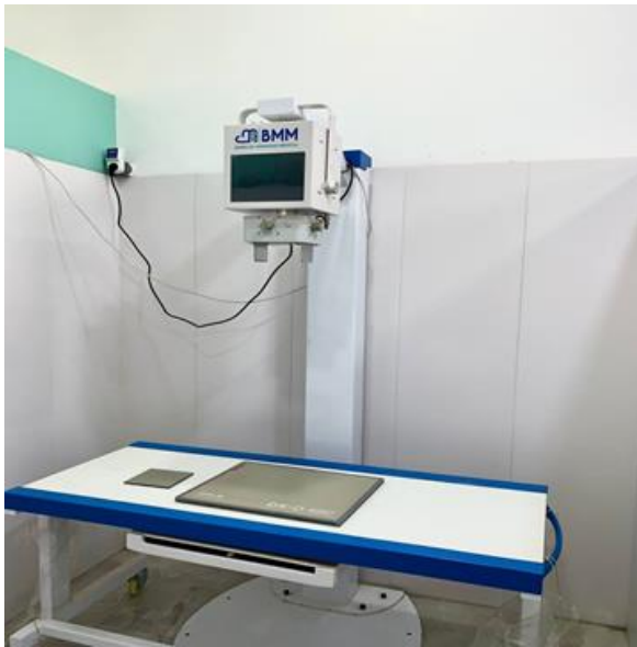
Figure 23: Appareil de radiographie numérique avec table de radiographie. (Photo personnelle,2025)
