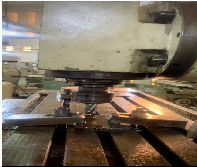
Figure IV.4 : Fixation de l'outil
