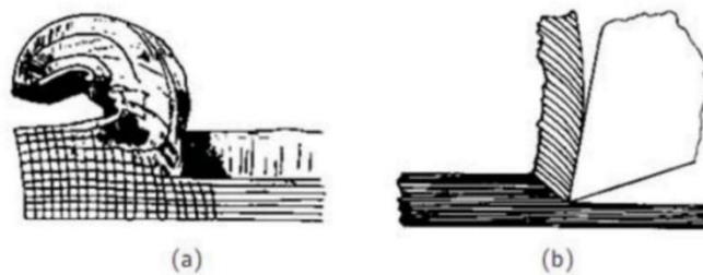
Figure II.1: Observations de la coupe des métaux (d'après Tresca et Mallock) [15]
