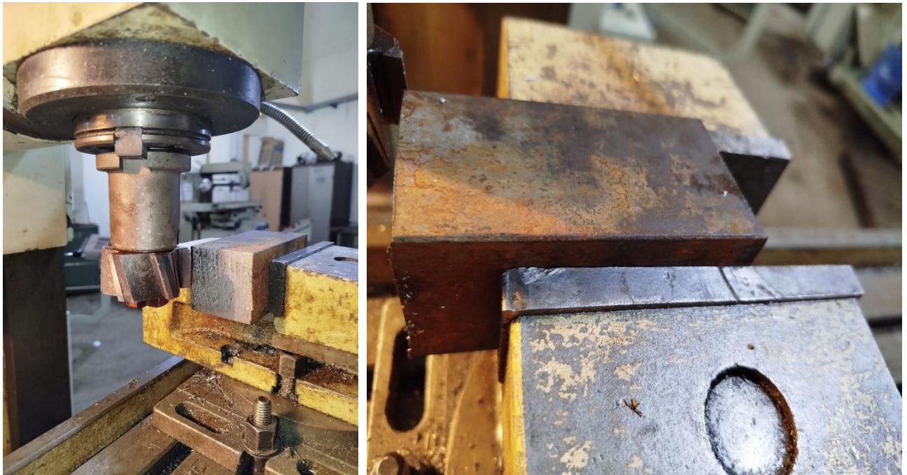
Figure III.21 : Fixation de la pièce et de l'outil
