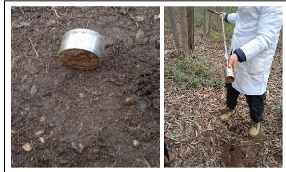
Figure17: Un cylindre métallique pour détermination de la densité apparente (2025, Original).
