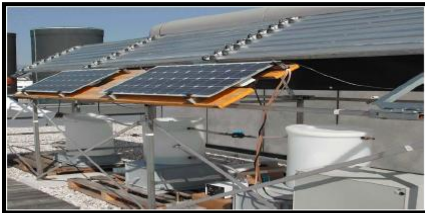
Figure (1.16): Pilote solaire (Photoréacteur à collecteur compose parabolique) utilisant des suspensions sur la plateforme permettant de dépolluer 300 litres d'eau par jour
