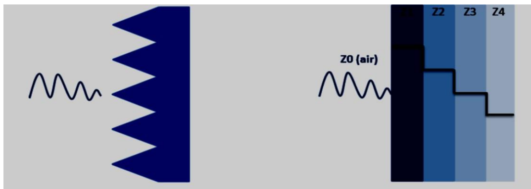
Figure I-8 Adaptation d'impédance appliquant (a) une transition géométrique utilisant la forme pyramidale et (b) une configuration multicouche [1]
