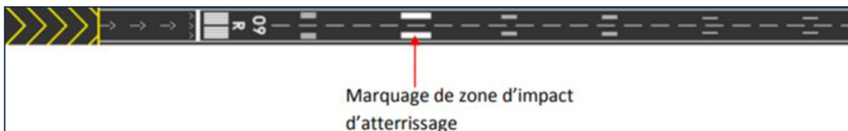
Figure 1. 9 : Marques de zone de toucher des roues. [4]
