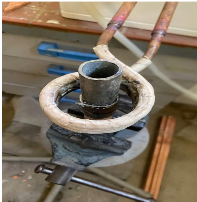
Figure 3.12: Montage destiné au brasage de tuyaux d'acier-cuivre avec la baguette d'Ag.
