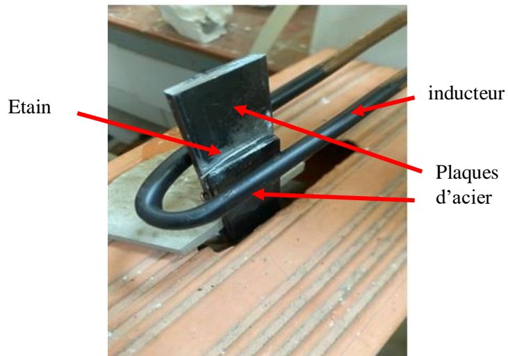
Figure 3.6: Préparation des échantillons à braser par chauffage à induction.
