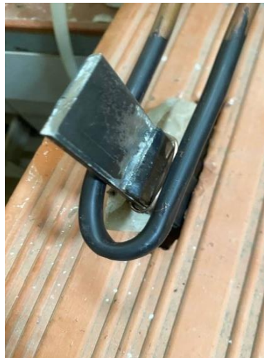
Figure 3.7: Brasage des plaques d'acier par induction à 17 T et P= 3.1 KW.
