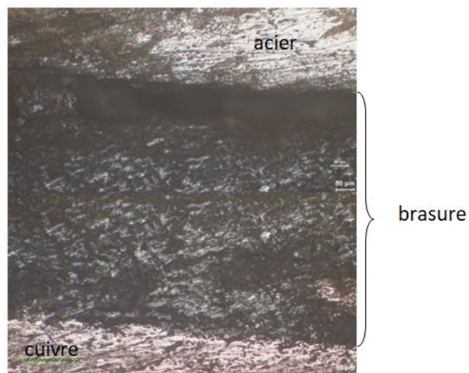
Figure 3.14: Coupe transversale des tubes acier-cuivre après brasage par induction.
