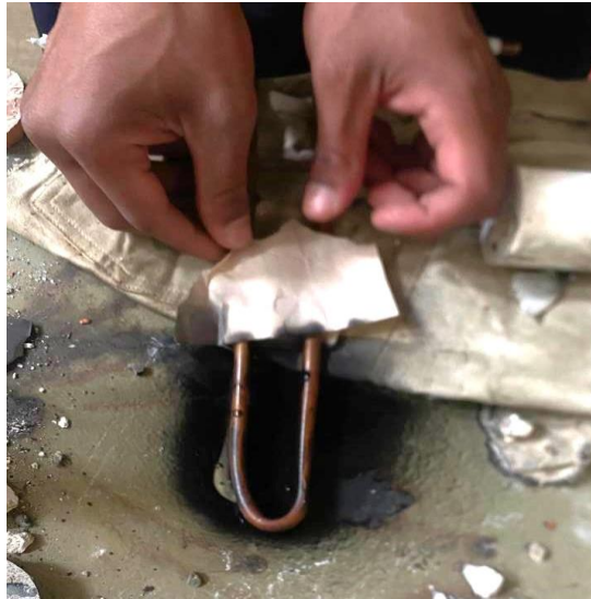
Figure 3.5: Façonnage de l'inducteur de cuivre pour l'opération d'induction.
