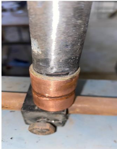
Figure 3.13: Brasage des tubes acier-cuivre par chauffage par induction.
