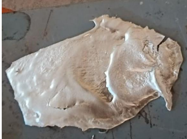
Figure 3.32: Alliage coulé de ZnAlSn produit à partir de la fusion 4.
