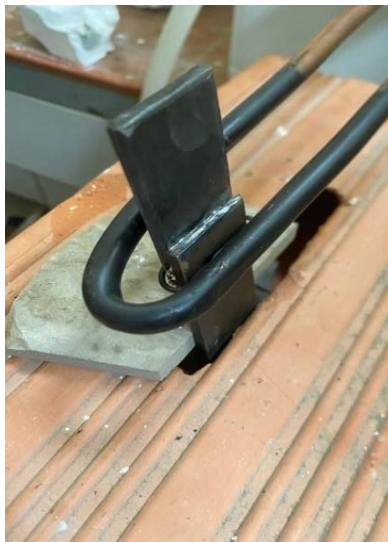
Figure 3.9: Brasage des plaques d'acier par induction à 12 T et P= 3.1 KW.
