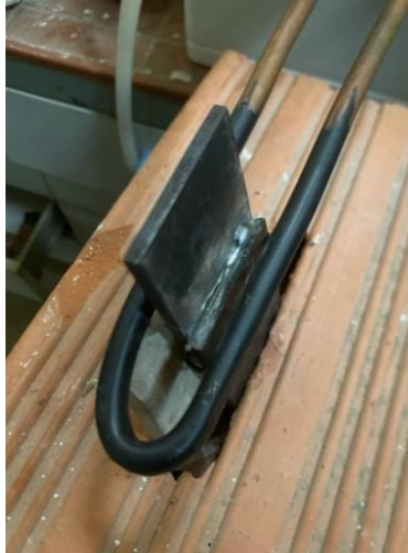
Figure 3.8: Brasage des plaques d'acier par induction à 15 T et P= 3.1 KW.
