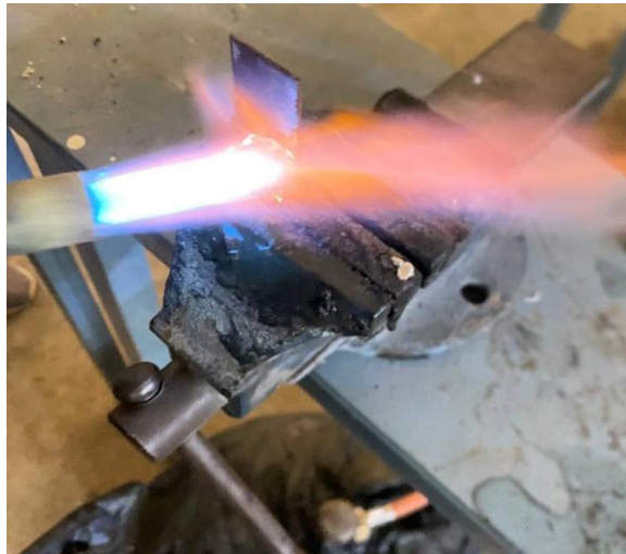
Figure 3.1: Le préchauffage des plaques au chalumeau Express et brasage.
