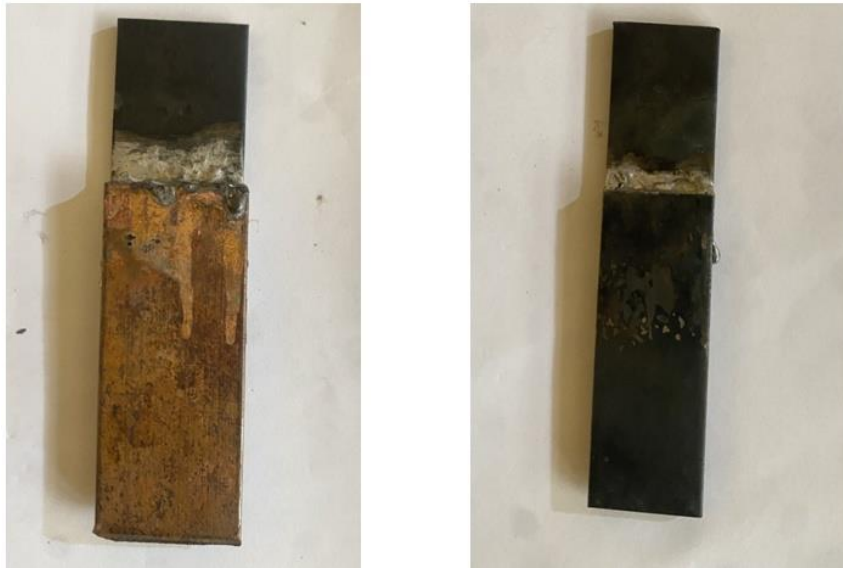
Figure 3.2: Brasage de plaques Cu-Acier et acier-acier a l'étain.
