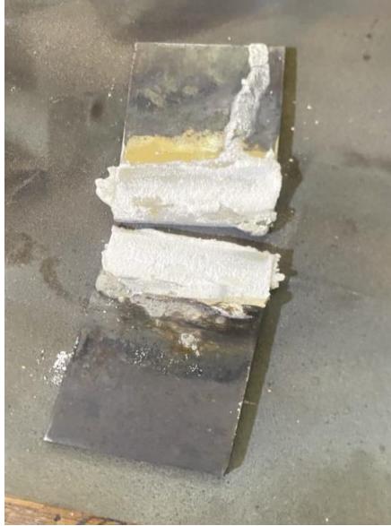
Figure 3.24: Brasage de deux plaques avec un métal d'apport en poudre AlCu broyée.
