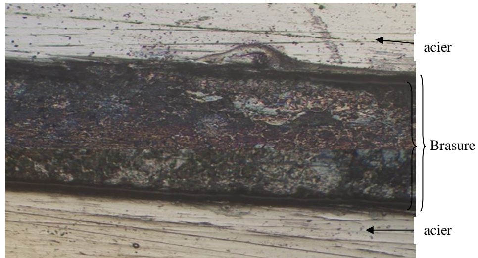
Figure 3.31: Coupe transversale du brasage avec la fusion 3 sur acier-acier.
