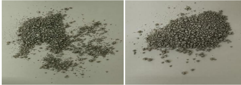
Figure 3.21: Aspect macroscopique des poudres AlCu après broyage de 1h et 1h30min.
