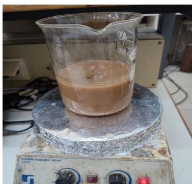
Figure II.13: Déminéralisation des carapaces de crevettes par HCL 3.85 %.
