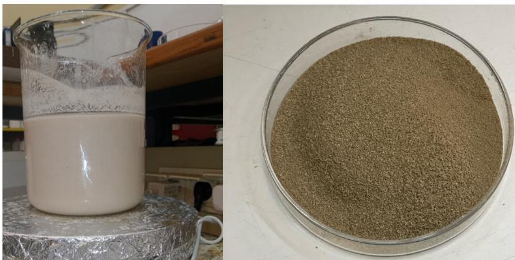
Figure II.16: Déacétylation de la chitine par NaOH 50.05% et obtention du chitosane.
