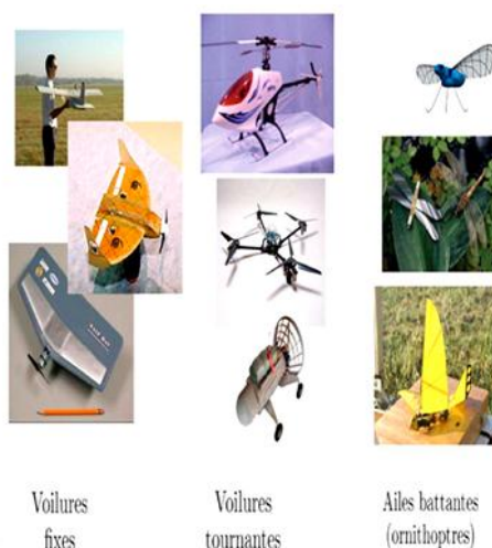
Figure 1.8 : Classification des drones selon la voilure.
