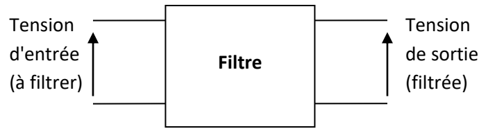
Figure 21. Représentation générale des signaux d'entrée et de sortie d'un filtre
