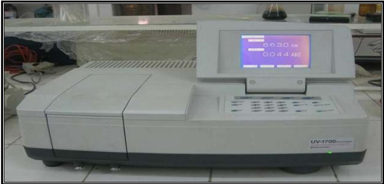
Figure.2.4 : Schéma représentatif d'un spectrophotomètre UV-Visible de type SHIMADZU-1700.
