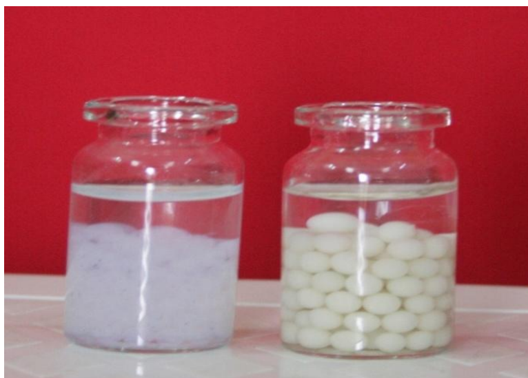
Figure 3.1 : Photographie numérique des billes gélifiées humides (à droite): CIME-AI ; (à gauche) : alginate de calcium (AC)
