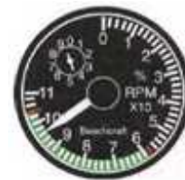
Tachymètre du générateur de gaz (Vitesse N1)
