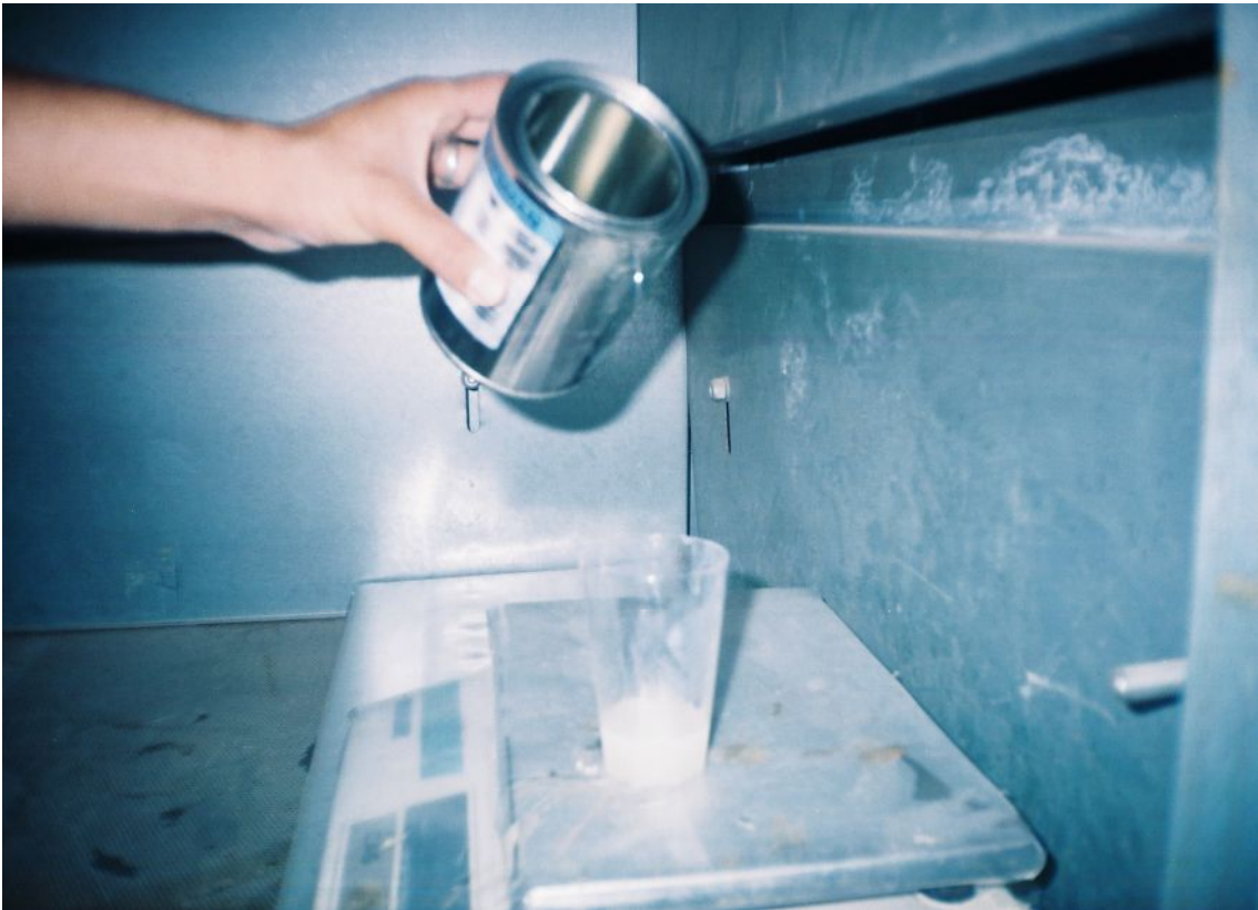
Figure (III-4) : Mélange de la résine avec son durcisseur
