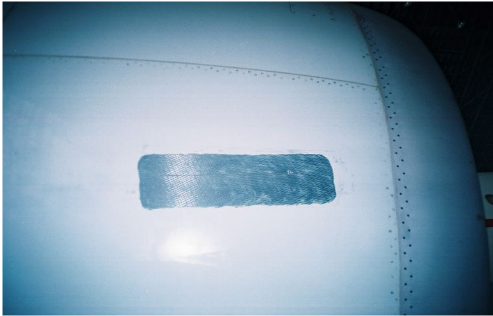
Figure (III-16) : Résultat du ponçage
